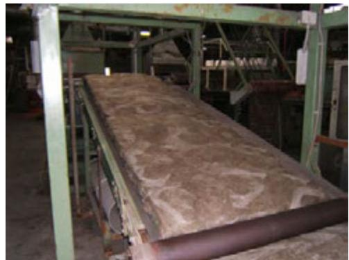
*Fig. 2: Lana di roccia incanalata nel nastro trasportatore*
