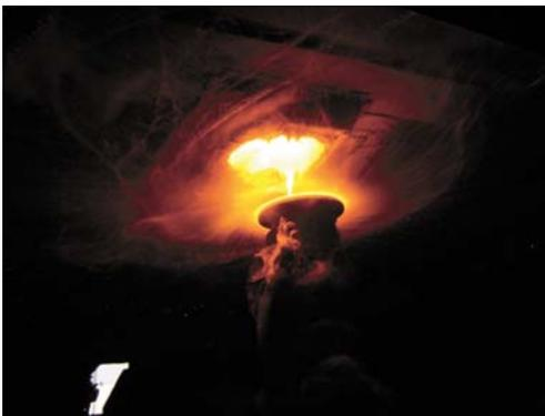
*Fig. 1: Il basalto fuso nel processo di centrifugazione”*
